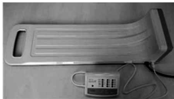
図1 振動マッサージ機（リラウェーブ） 縦616mm×横182mm×高さ144mm
